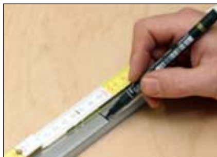
2 Kürzungsseite: Bandseite, Seite mit Auslöseknopf Auslöseknopf abschrauben Schnittstelle anzeichnen
